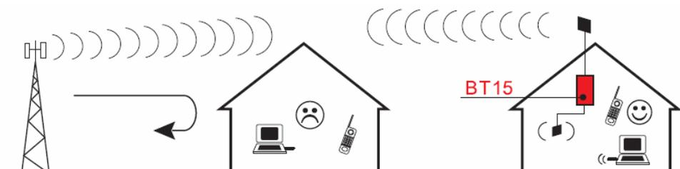
Il **BT15 Versione Mono-operatore** è preferibile quando il segnale esterno è basso ed è richiesta la ripetizione di **un solo operatore** in banda UMTS. E' possibile ripetere più operatori purché le celle si trovino nella stessa direzione, entro l'angolo di copertura di 60° dell'antenna di ingresso. Copertura interna **fino a 100-200m<sup>2</sup>**.
